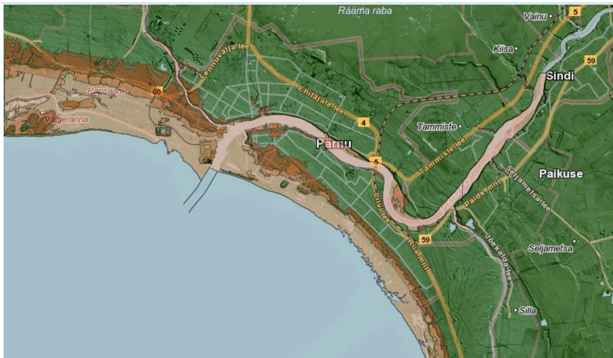
Joonis 3. Üleujutusohuga ala Pärnu jõe piirkonnas. Üleujutusala on joonisel tähistatud beežide-pruunide toonidega, üleujutuse esinemistõenäosus (alates heledamast toonist) on võimalik maksimaalne veetaseme tõus vastavalt 10, 50, 100 ja 1000 aasta jooksul 13
